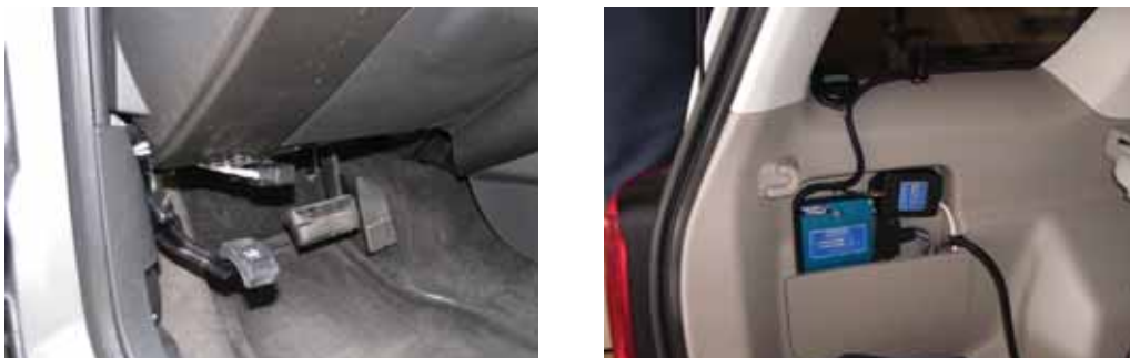
Fig. 2 – Exemples des composantes visibles pour le participant (connecteur, fils et unité de capture)
